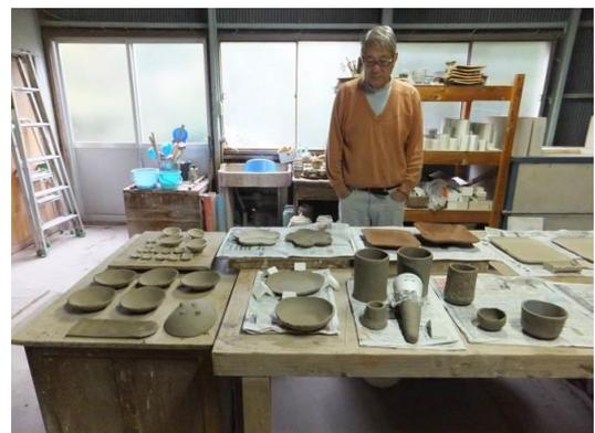
(翌朝写す・手前縦4列が我々4人の器物、これを十分に乾燥させ、700-900度で素焼きしたものに絵付け、釉薬(ゆうやく)を掛け強度を増して吸水性をおさえ、ここが肝心要、作品の良し悪しを左右する工程、最後の本焼きは1200-1300度の高温で焼き締めて完成です)
